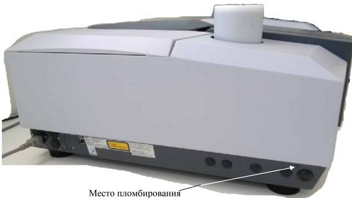
Рисунок 2 - Фурье - спектрофотометр инфракрасный IRTracer-100 (вид сбоку) с обозначением места пломбирования
