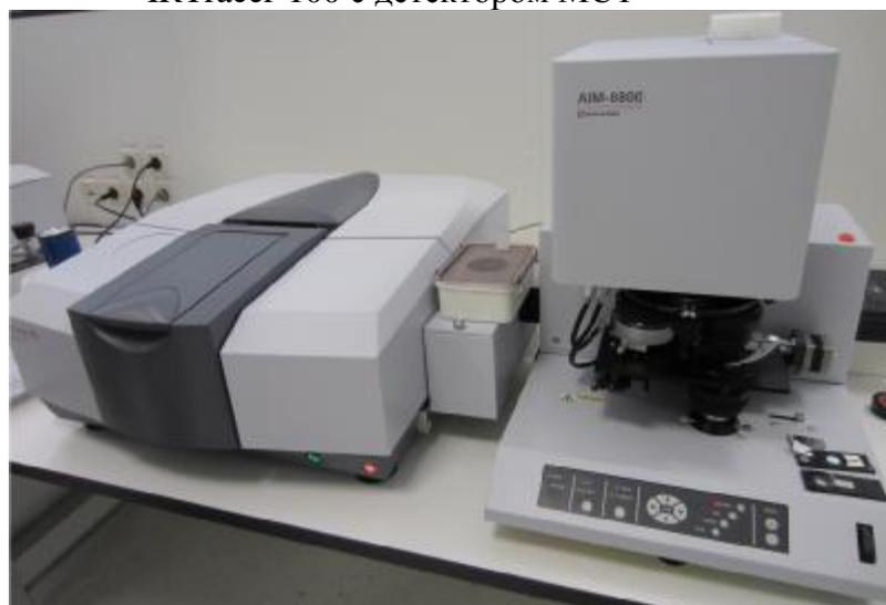
Рисунок 4 - Общий вид Фурье - спектрофотометра инфракрасного IRTracer-100 с инфракрасным микроскопом AIM-8800
